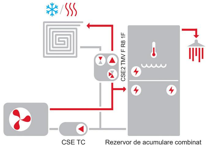
Diagramele prezintă exemple de conectare a unui grup de pompare la un sistem de încălzire cu un rezervor de acumulare combinat. Grupurile de pompă RGMAT și CSE TC trebuie comandate separat.
