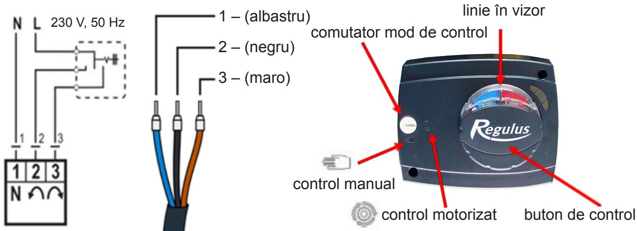
**Actuatorul este setat din fabrică pentru control motorizat și este gata de funcționare. În cazul în care este inevitabilă îndepărarea sau înlocuirea acestuia, vă rugăm să urmați instrucțiunile din anexă.**
