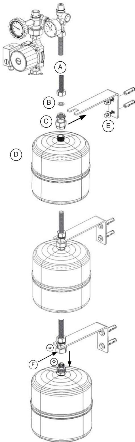
(A) Conductă flexibilă de  $\frac{3}{4}$ " pentru conectarea la o supapă de siguranță a stației de pompare (nu este inclusă în livrare).
